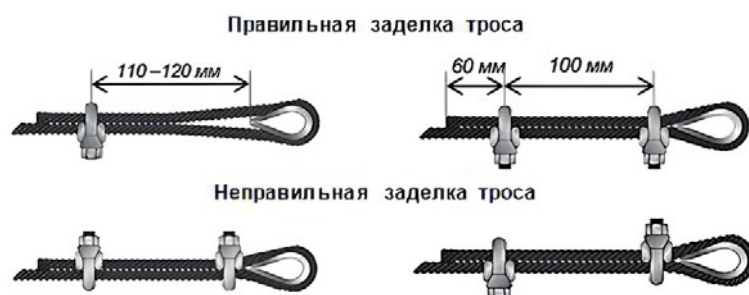
Рисунок 6 – Заделка троса
